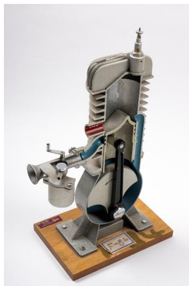
Pohyblivý model dvoudobého spalovacího motoru, inv. č. P2237
